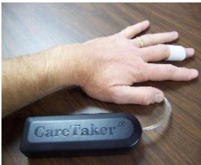
全く新しい概念で開発されたワイヤレス血圧計です。しかし、この理論は1世紀以上古く発見されていました。これは、観血式血圧波が、大動脈血管内の反射波の合成から成り立っているという事実から応用されました。現代の高速化したパソコンにより実現したものです。無線化は、現代のブルーツース技術を採用しています。
