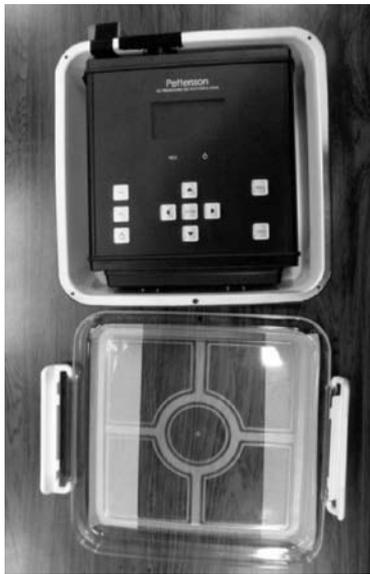
写真 1 自作したハウジング内の D500X
